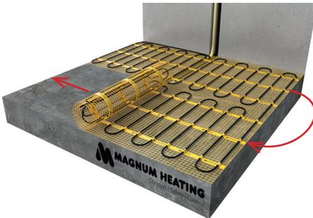
Bei Installation in Fliesenkleber (Punkt 11): Rollen Sie die MAGNUM Mat mit dem Heizkabel nach unten aus, so dass Sie nur das Glasfasernetz sehen. Bestimmen Sie, wie die Matte liegen sollte. Bei der Verarbeitung sind viele Variationen möglich.
