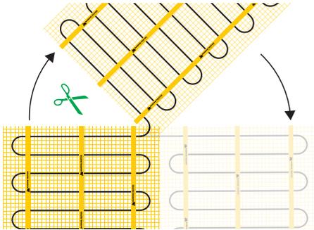
Bei Ausgleichs-/Gussmörtel (Punkt 10): Rollen Sie die MAGNUM Mat mit dem Heizkabel nach oben aus, so dass Sie die Heizkabel sehen können. Damit vermeiden Sie, dass das Glasfasernetz auf dem Ausgleichs- bzw. Gussmörtel "treibt". Eventuell können Sie die Matte mit Hilfe von Fliesenkleber fixieren. Mit Ausnahme der MAGNUM Mat Small, diese hat eine selbstklebende Rückseite.
