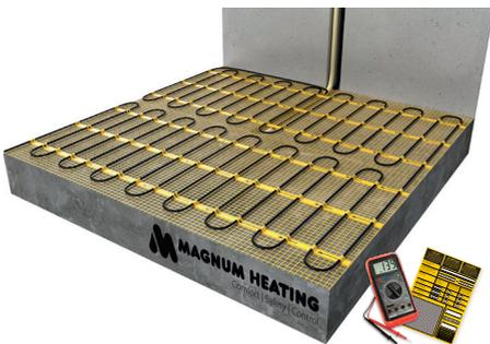
vullen op de gele kaart (middenpagina). Meet tussen de weerstandsdraden en gebruik hiervoor het tabel weergegeven in punt 2. De Ohmse waarde mag max. 5% afwijken. Meet ook tussen de weerstandsdraad en de aardmantel. Bij deze meting mag de meter niet uitslaan, mocht dit wel het geval zijn dan contact opnemen met de supportline.
