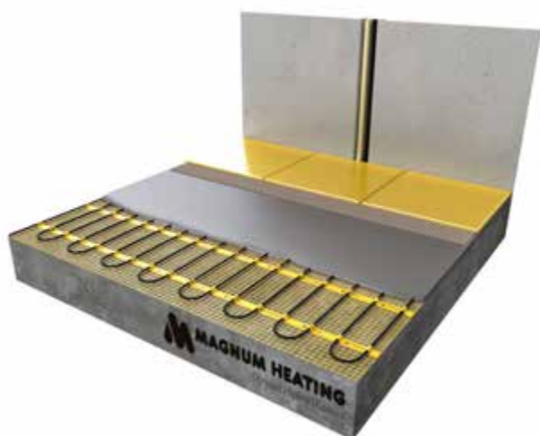
Installatie in egalisatie
