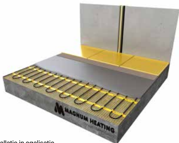
Installatie in egalisatie
