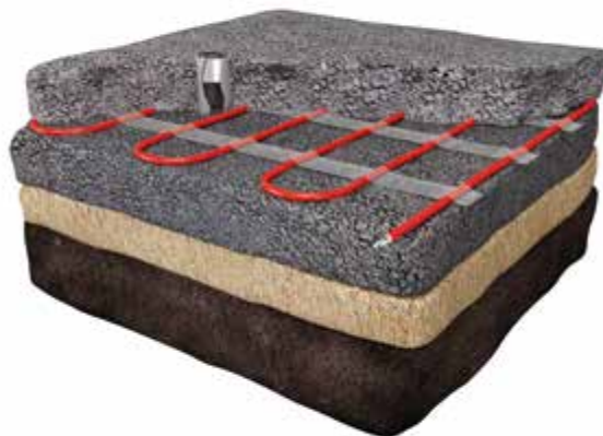
Installatie in ongewalst asfalt
